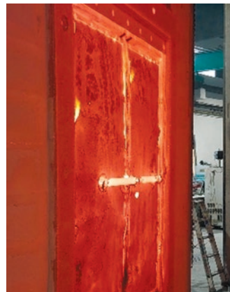
Feuerresistente Tunneltüre: Die HPFC-Innovation aus Micheldorf im erfolgreichen Brandversuch sowie beim ersten Einsatz in Dänemark.
