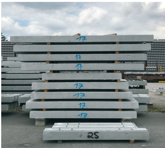
Produktion in Sollenau: Die Holzersatz-Weichenschwellen WS 175HE werden im Schwellenwerk in Sollenau produziert.
