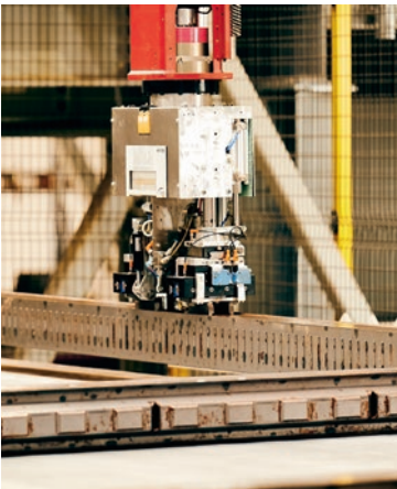
Links: Der Entschalungs- und Schalungsroboter identifiziert die Schalungen auf Basis einer Kamera und eines Laserscanners. Rechts: Nachbearbeitungsstation und Härtekammer.
