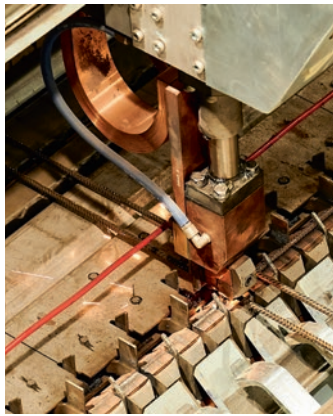
Bis zu 200 m 2 Bewehrungsmatten pro Stunde werden in variabler Größe verschweißt.
