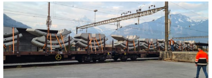
Bild links: Gleisarbeiten für den Bahnanschluss bei der Katzenberger Fertigteilindustrie. Rechts: Ankunft eines Tübbing-Zugs in der Schweiz.
