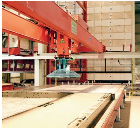
Links: Der Entschalungs- und Schalungsroboter identifiziert die Schalungen auf Basis einer Kamera und eines Laserscanners. Rechts: Nachbearbeitungsstation und Härtekammer.
