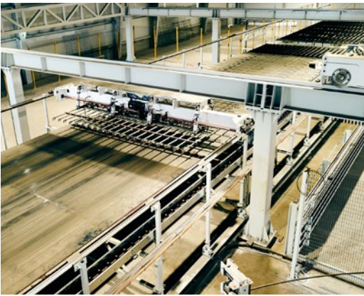
Bis zu 200 m 2 Bewehrungsmatten pro Stunde werden in variabler Größe verschweißt.
