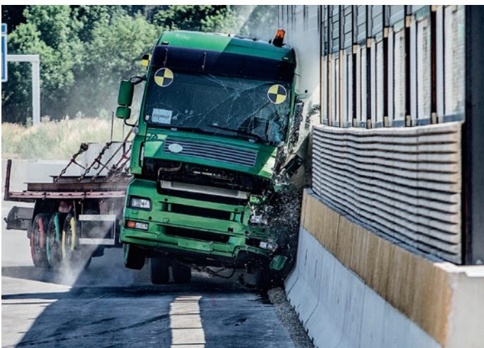
DB NBF-System im Crashtest: Das Top-Produkt im Portfolio der Kirchdorfer Road & Traffic-Sparte kombiniert den bewährten DELTABLOC® Aufprallschutz mit Lärmschutzelementen, die mit flexibler Gestaltung und Materialwahl integriert werden können.
