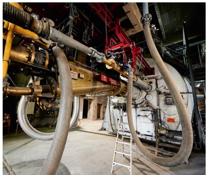
Die als Ersatzbrennstoff eingesetzte Leichtfraktion wird am Weg durch das 40 m hohe Steigrohr vorgetrocknet und gefiltert (Bild links) und danach über einen separaten, sogenannten Satellitenbrenner in das Drehrohr eingeblasen. Bild rechts: Drehofen Hauptbrenner mit separatem Satellitenbrenner (das kleinere, betonummantelte Rohr auf der rechten Seite).
